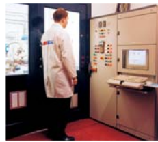
Автоматизированное испытательное оборудование стандарта API 682 с компьютерным управлением, установленное в главном британском филиале компании.
