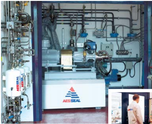
Автоматизированное испытательное оборудование стандарта API 682 с компьютерным управлением, установленное в главном британском филиале компании.
