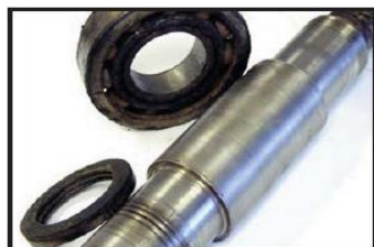
Повреждение вала от лабиринтного уплотнения
