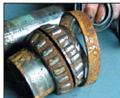
Вышедший из строя подшипник
