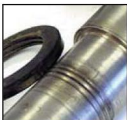
Повреждение вала от лабиринтного уплотнения
